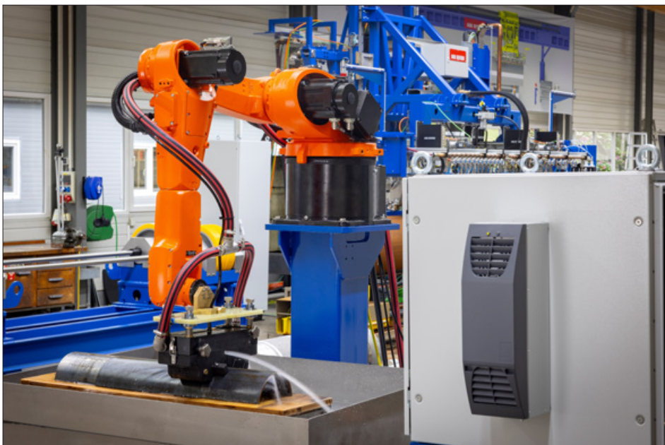
ECHOGRAPH SNHF PAUT-Systemübersicht: Roboterarm mit Prüfkopfhalter, Phased-Array-Elektronikschrank und Kalibrierstation
