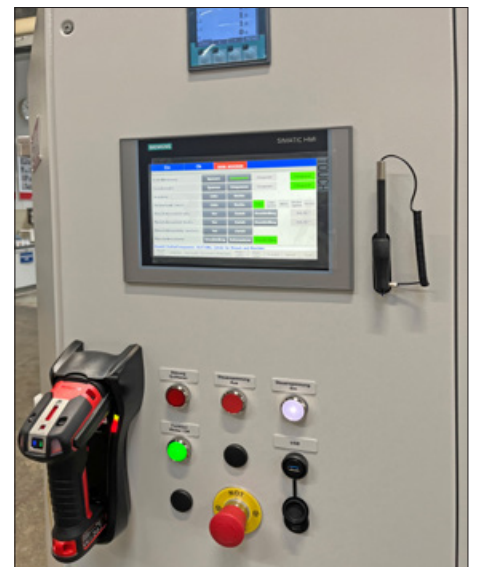
Parameterspeicher DEUTROFLUX MEMORY CONNECT mit zusätzlichem Handscanner zur Bauteilidentifizierung
