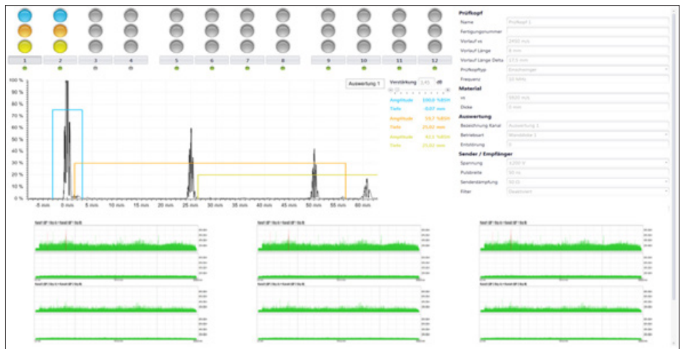
Leistungsfähige und kundenspezifische ECHOVIEW-Ultraschallsoftware: Hier ein Beispiel mit neun Amplitudenschrieben (Amplitude über Weg aufgetragen)
