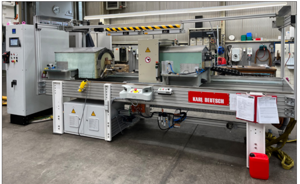
Gesamtansicht der Prüfanlage DEUTROFLUX UWS 1500 SPEZIAL inkl. pneumatischem UV-Leuchtenhalter für bessere Kranbeladbarkeit
