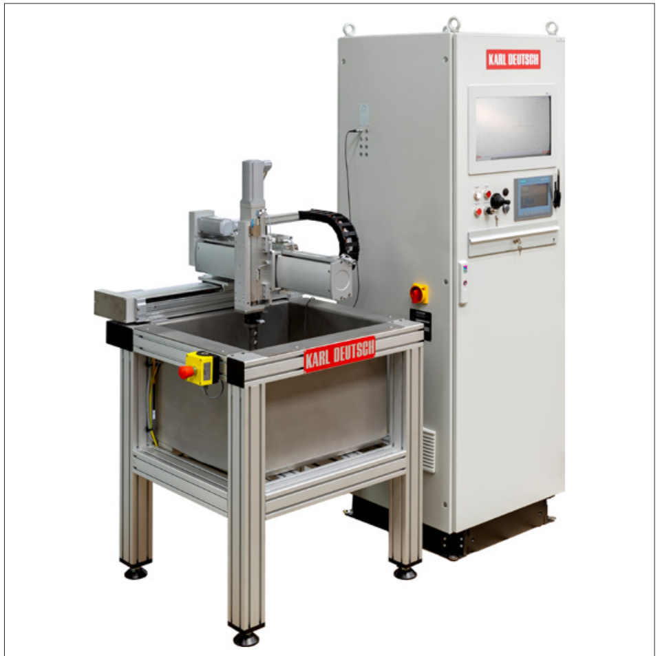
US-Prüfmechanik ECHOGRAPH 1170 für Stahlzylinderblöcke
