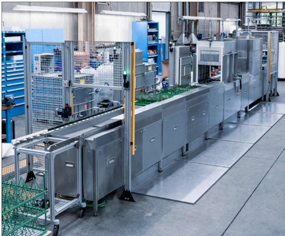
Vollautomatische Prüfanlage für die Eindringprüfung mit wasserabwaschbaren Eindringmitteln
