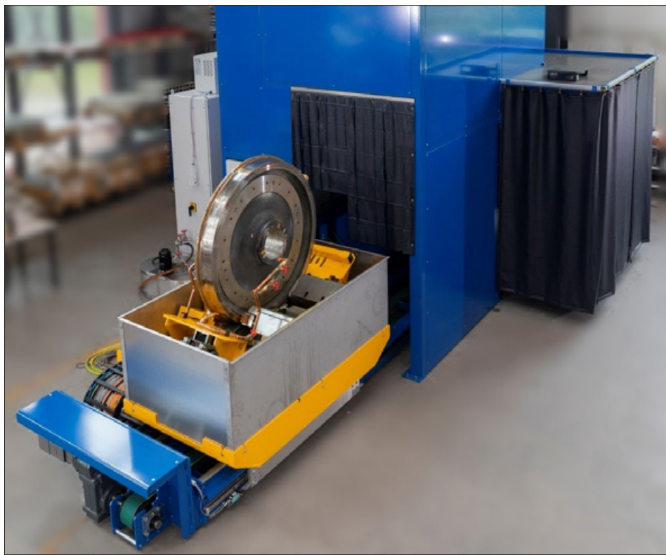
Beladeschlitten mit eigens angefertigtem Testrad mit künstlichen Fehlern zur Prozessvalidierung im Zuge der Vorabnahme
