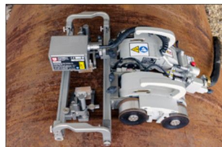
NAVIC 2 mit RVI und optionalem Laser-Tracker
