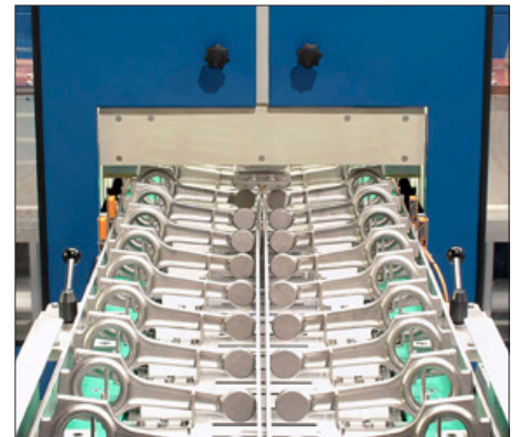
Leistungsfähige Rissprüfanlage vom Typ DEUTROMAT mit einer Taktzeit von 2,5 Sekunden pro Bauteil (Pleuel)
