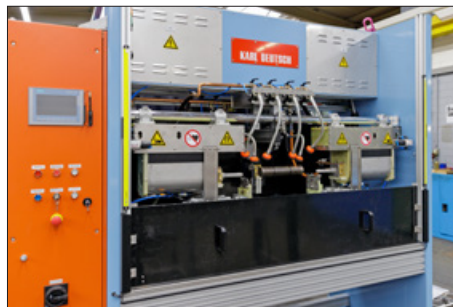
Frontansicht DEUTROMAT DAS-1U: Magnetisierungsstation mit zwei Wechsel-Dornen, die jeweils über eine Innenbespülung verfügen
