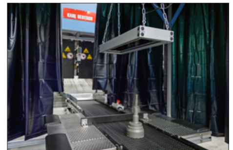
Betrachtungsarbeitsplatz in der Verdunkelungskabine im hinteren Anlagenbereich
