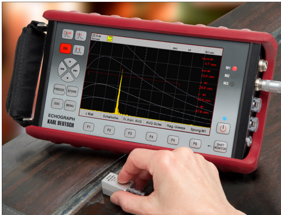
ECHOGRAPH 1095 mit den Bewertungsmethoden AVG, DAC, TCG
